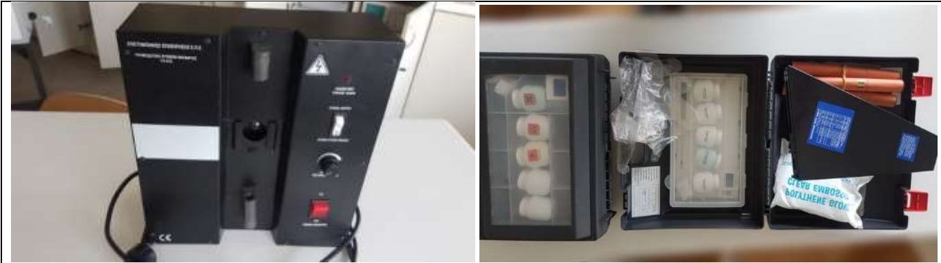
ΚΔ3: Φασματοσκόπιο με δείγματα αερίων και για πυρανίχνευση μετάλλων Δείτε: Παρατήρηση συνεχών και γραμμικών φασμάτων (video)
